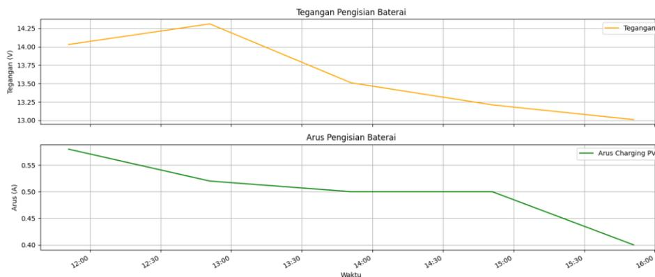
**Gambar 3.** Grafik Pengujian Tegangan dan Arus Baterai
