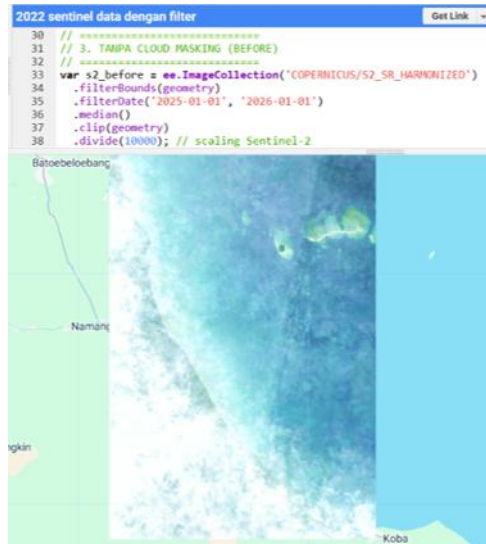
Gambar 5 Kondisi permukaan sebelum pembersihan awan
