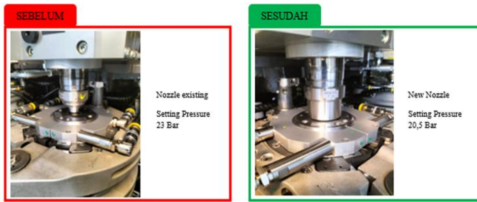
Gambar 1. Mendesain Ulang Fixed Mouth Nozzle Untuk Efisiensi Energi Udara Bertekanan Pada Proses Blowing Botol Pet 1500 Ml Di Industri Manufaktur
