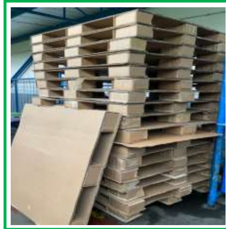
Gambar 1. Inovasi Eco-Pallet Berbahan Carton sebagai Solusi Pengurangan Limbah dan Efisiensi Biaya Produksi PT Tirta Investama Pabrik Mambal
